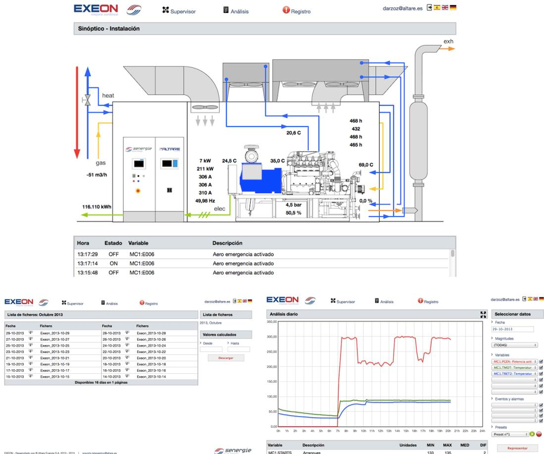
**Figura 8: Pantallas de monitorización en el sistema EXEON COGEN.**
